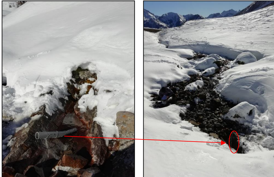
Photo 6 : sonde de température/conductivité installée à la source de la Chapelle
